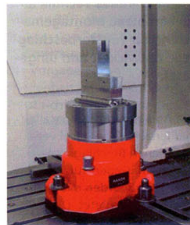
Standardaufnahmevorrichtung für das Schnellwechseln flacher kubischer Teile
