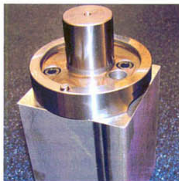
Der kubische Rohling wird auf den Aufnahmeffansch geschraubt...
