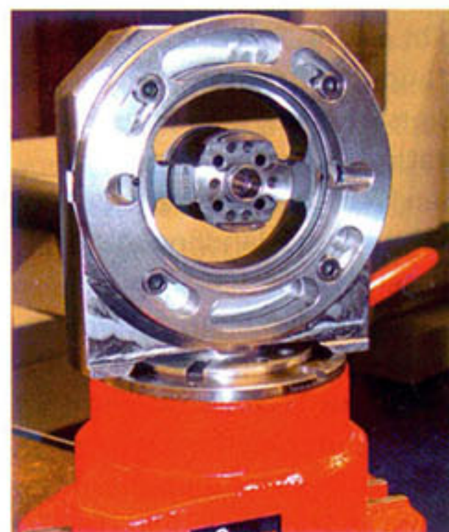
5-seitige-Vorder- und Rückseitenbearbeitung eines Flansches mit Schnellwechselladung
