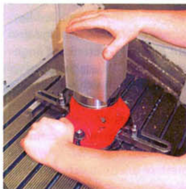
...in den Manok verdrehgesichert eingesetzt und gespannt...
