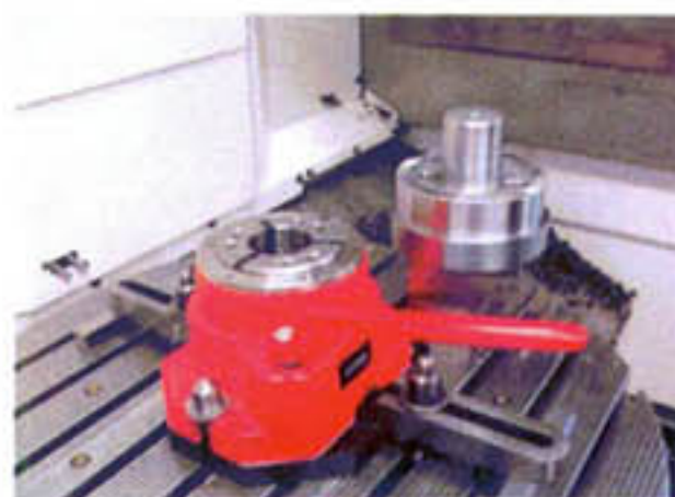
Manuell betätigter Spannstock Manok für \varnothing 65 und Aufnahmeffansch
