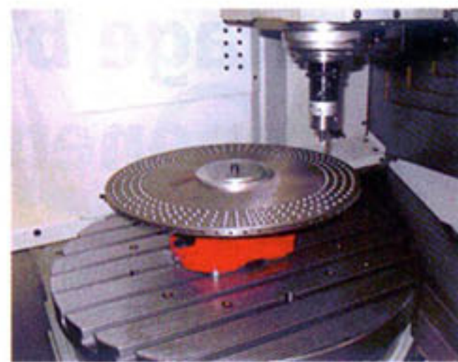
Horizontales und vertikales Bohren von 360 Passbohrungen
