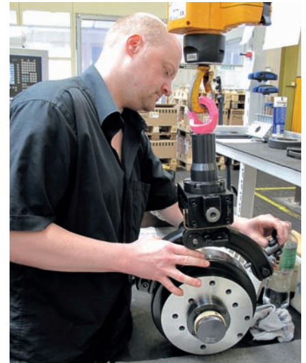
4 Auch mit dem Klassiker, dem Captex-System, lässt sich das Werkstück – hier an der Schleifmaschine – fix wechseln und spannen
