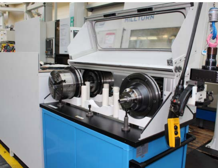
Die Spannmittel warten auf ihre Einwechslung. Der Ablagewagen ist eine Eigenkonstruktion von Arburg.
