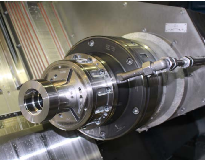
Auch die Gegenspindel der Drehmaschine ist mit den Centrotex-Adaptoren ausgerüstet.
