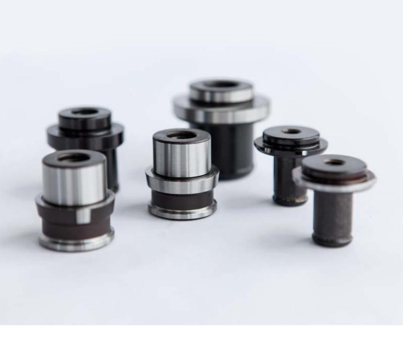
Die Spannbolzen sind ein wichtiger Bestandteil des DockLock Systems und schaffen die Verbindung zwischen Spannmodul und Wechselteil. Sie fühlen sich überall wohl und können in die Grundplatte, ins Spannmittel oder direkt ins Werkstück eingesetzt werden. Die Zentrierspannbolzen richten sich durch einen hochgenauen Bund in der Spannstelle des Spannmoduls aus. Das sorgt für eine Wiederholgenauigkeit von ≤ 0,005 mm.
