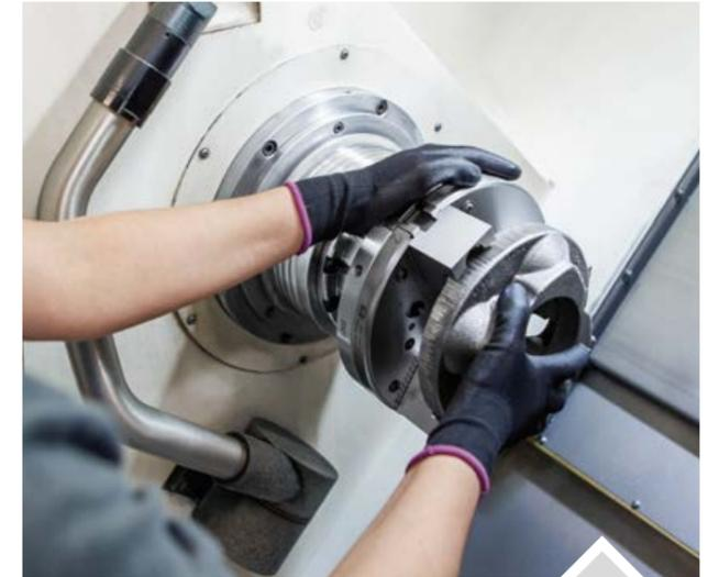
Ich setze das Backenmodul ein, sichere es mit einer Schraube und schon ist es zentriert. Ist alles in maximal 2 Minuten erledigt. Werkstück einspannen und von allen Seiten oder zwischen den Backen bearbeiten. Doch das Beste: Ich muss kein ganzes Backenfutter umrüsten.
