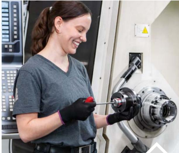
Wie Sie sehen, habe ich den Spannkopf bereits aus dem Spannutter entnommen. Ich halte die Adaption MANDO Adapt T211 in der Hand, habe die Segmentspannbüchse eingesetzt und schraube jetzt noch den Zugbolzen fest.
