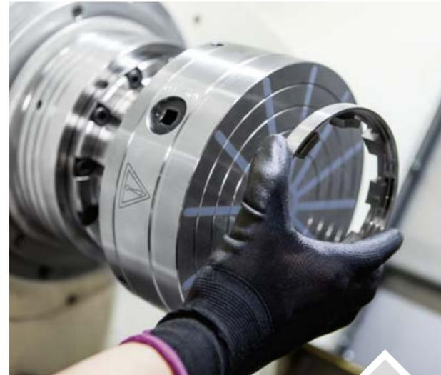
Damit spannen Sie das Teil axial auf einem Neodym-Magnet und das Magnetmodul wird an die Plananlagefläche auf das Basis-Spannmittel gezogen. Sie wissen ja: 30 Sekunden ohne ...
