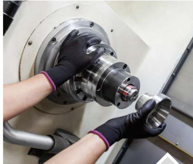
Die Adaption ins Spannutter einzusetzen hat keine Minute gedauert. Auch hier muss ich nichts ausrichten und kann mein Werkstück sofort einspannen. Und keine Sorge, selbst bei einer kurzen Spannlänge haben Sie noch hohe Haltekräfte.
