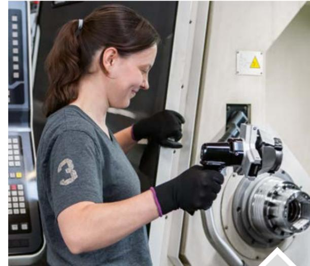
Das Basis-Spannmittel – das Spannfutter TOPlus mini – habe ich bereits auf die Maschine geschraubt. Ich schnapp mir meine Wechsellösung mit dem Spannkopf und setze ihn sicher ins Spannfutter ein.
