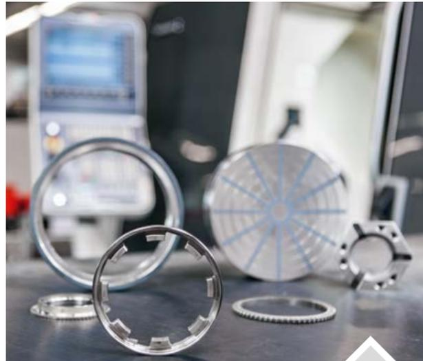
Ist aufgrund der Kontur das Teil schwer zu spannen oder kann es durch die Radialspannung deformiert werden, ist das Magnetmodul mit seiner magnetischen Axialspannung eine gute Lösung.
