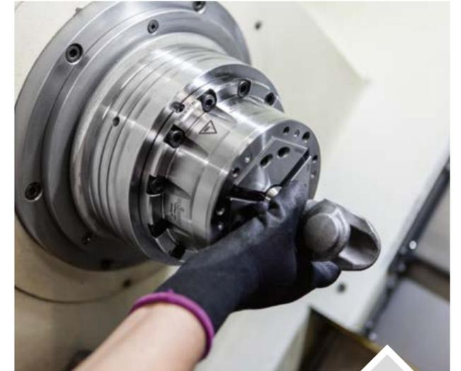
Geht superschnell und ich muss nichts ausrichten. Nun kann ich mein Werkstück für die Bearbeitung von außen einspannen und die Maschine starten. Noch ein Hinweis: Durch die einzigartige Steifigkeit sind hohe Zerspanparameter kein Problem.
