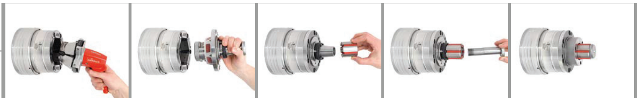
Spannkopf entnehmen MANDO Adapt T211 einsetzen Segmentspannbüchse aufstecken Zugbolzen einschrauben Spannmittel gerüstet
