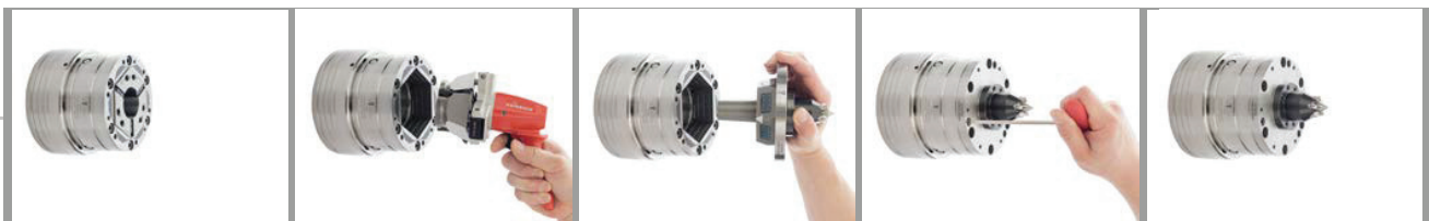
Spannmittel mit Spannkopf Spannkopf entnehmen Stirnmitnehmer einsetzen Stirnmitnehmer sichern Spannmittel gerüstet
