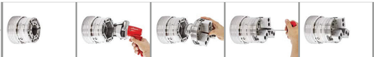
Spannmittel mit Spannkopf Spannkopf entnehmen Backenmodul einsetzen Backenmodul sichern Spannmittel gerüstet
