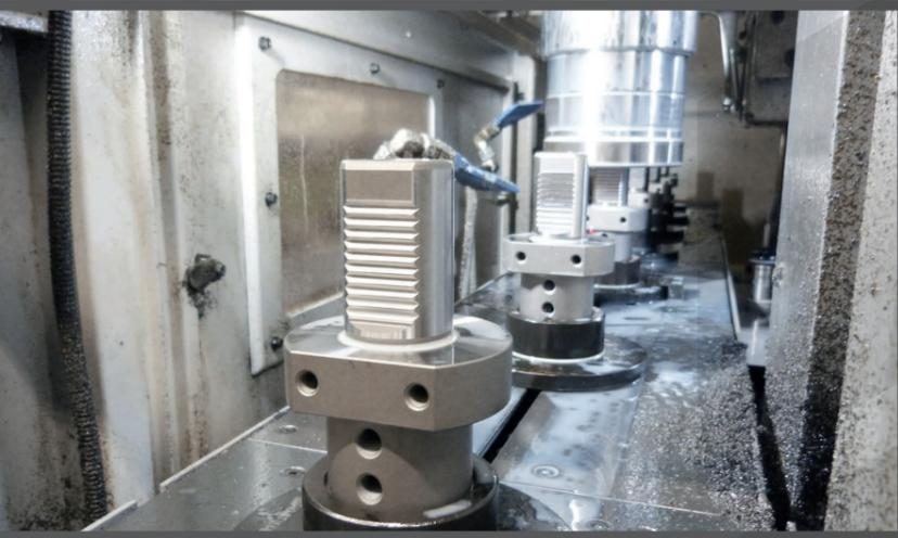
Die Pick-up-Station wird mit 20 Grundhaltern bestückt und läuft dann mehrere Stunden mannos.
