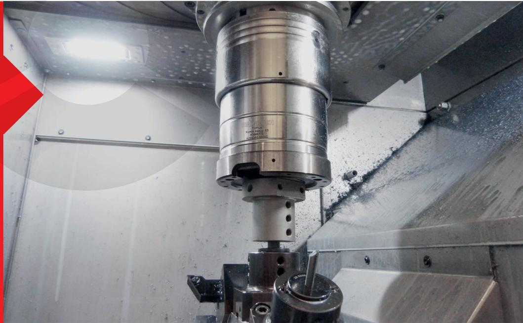
Das hochpräzise Spannfutter Toplus premium spannt die hochpräzisen Bauteile auf der Emag.
