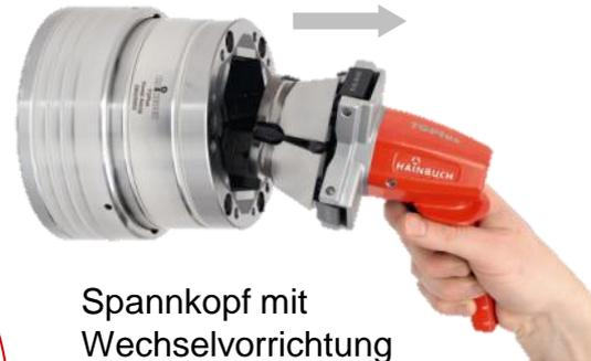
Spannkopf mit Wechsellvorrichtung entnehmen
