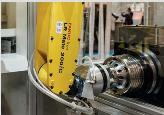
Roboter setzt Spannkopf in Spannmittel ein.
