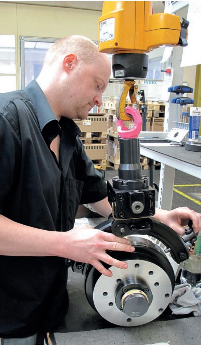
Auch mit dem Klassiker, dem capteX-System, lässt sich das Werkstück – hier an der Schleifmaschine – fix wechseln und spannen.
