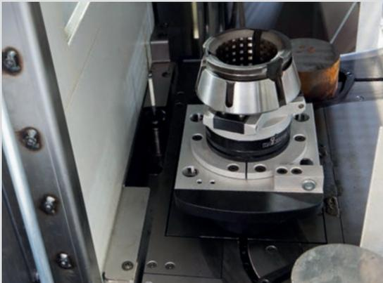
Ablage- und Wechselstation auf dem Werkstückzufuhrband zum Einwechseln des Spannkopfes.
