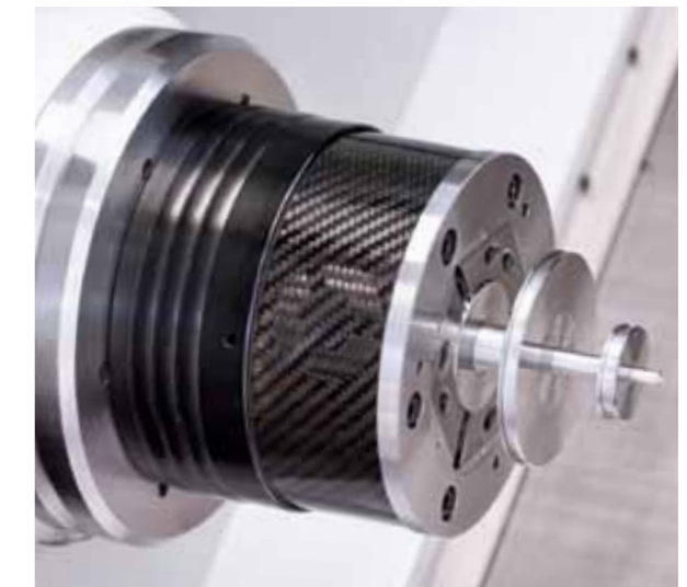
Anwendungsbeispiel des neuen TOPlus Leichtbau-Futters beim Bearbeiten einer Welle.
