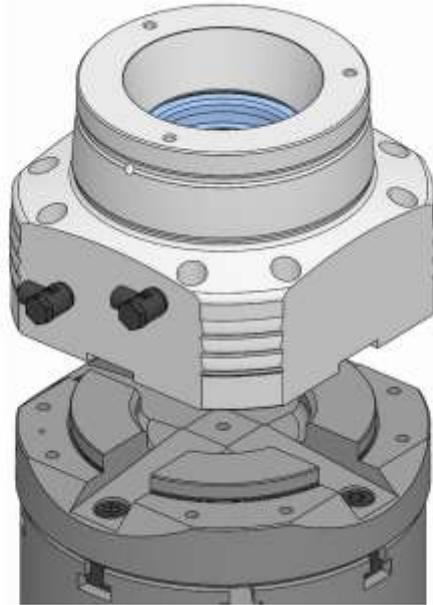
5. Das Produkt auf den Maschinentisch / die Grundplatte aufsetzen.
