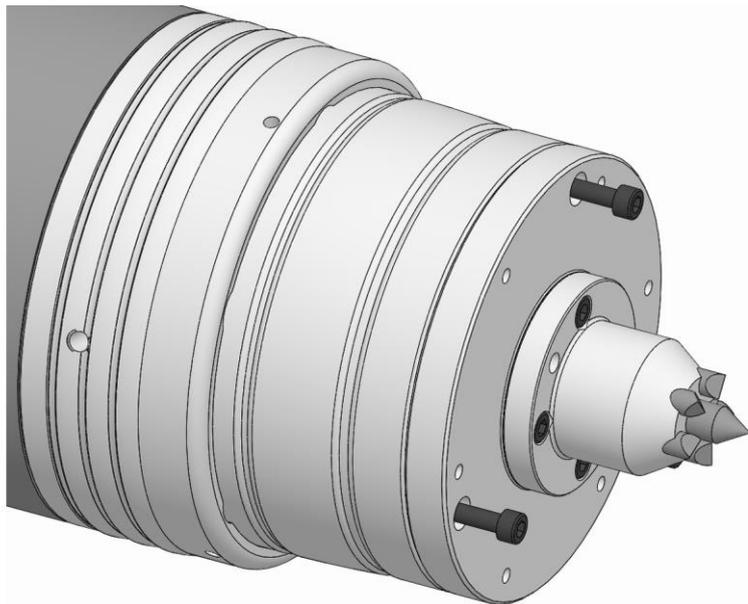
4. Die Befestigungsschrauben Adaptionsspannmittel einschrauben und diese mit dem vorgeschriebenen Anzugsdrehmoment festziehen [siehe Kapitel »Schraubenanzugsdrehmomente«].
