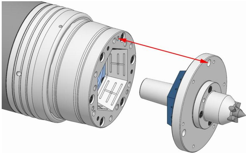
3. Das Adaptionsspannmittel auf das Basisspannmittel aufsetzen, sodass das Bohrbild am Basisspannmittel und dem Adaptionsspannmittel übereinstimmt. Dabei müssen die Flächen des Spankegels im Basisspannmittel und am Adaptionsspannmittel übereinstimmen.
