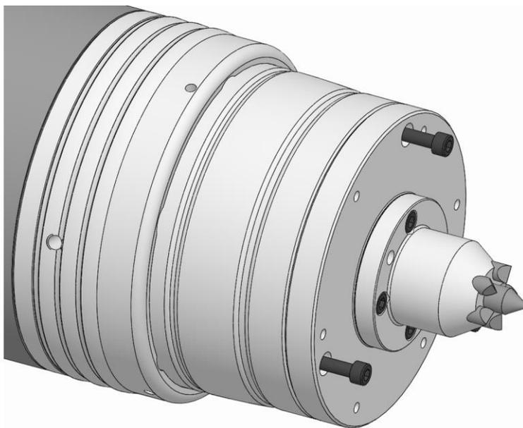
3. Die Befestigungsschrauben Adaptionsspannmittel lösen und entfernen.
