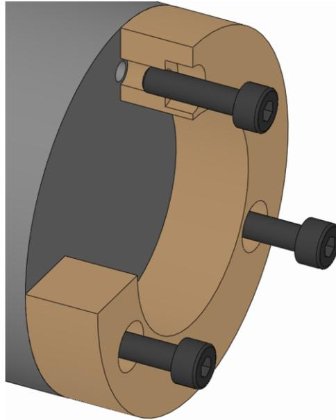
1. Die Befestigungsschrauben Wechselteil lösen und entfernen.
