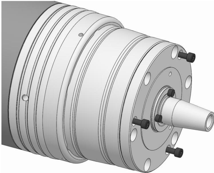
5. Die Befestigungsschrauben Adaptionsspannmittel lösen und entfernen.
