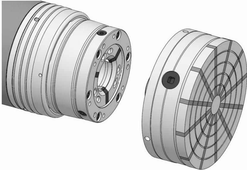
5. Das Adaptionsspannmittel aus dem Spannkopf Adaptionsspannmittel herausnehmen.
